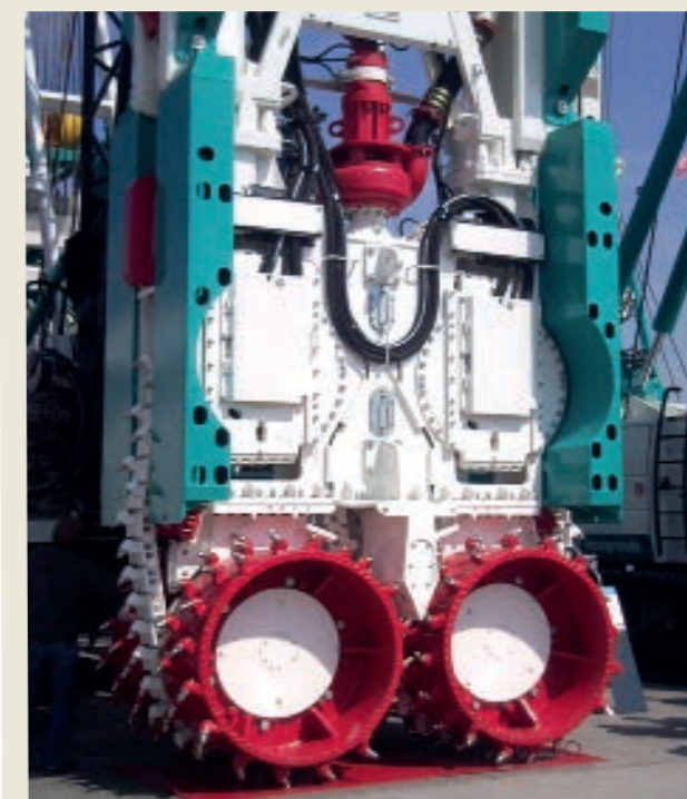
Траншеекопатель с насосом КВКТ-V1 сверху
